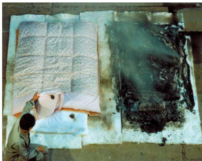
布団燃焼実験（左：防災品 右：非防災品） ～タバコを布団におき、同時着火1時間～
